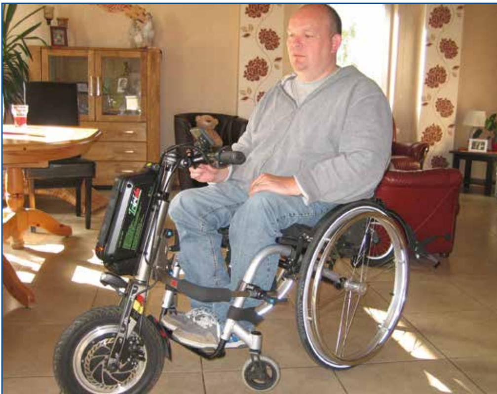
der Rahmen des Elektro-Rads aufgesteckt. Unterhalb des Lenkers hängt der aufladbare Akku, der das Gerät mit dem nötigen Strom versorgt.
